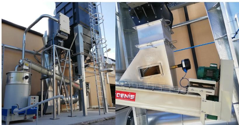
Le pilotage du système est assuré automatiquement. Les gaines d'aspiration machines sont équipées d'une trappe électropneumatique. L'ouverture / fermeture de chaque trappe est asservie au démarrage machine.
