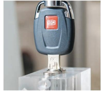
et de torsion (jusqu'à 20 kilonewtons et 200 newtons) ainsi que d'outils de mesure précis pour tester la surveillance des équipements.
