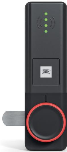
Das ENIQ LoQ basiert auf der Hebelzylinder-Technologie, die zumeist für Schließfächer, Briefkästen und Stahl- oder Holzschränken verwendet wird. Auf der Rückseite des Schlosses befindet sich ein Hebel, der sich bei Betätigung des Drehknaufs um bis zu 90° dreht. Da das Schloss mit einer großen Vielzahl an unterschiedlichen Hebeln erhältlich ist, passt es praktisch in jede Anwendung.
