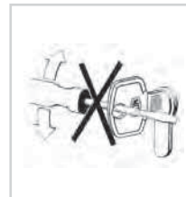
Am Schlüsselkopf dürfen keine Hilfsmittel (Zange, Nagel o.ä.) angesetzt werden.
