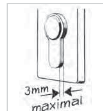
Zylinder darf maximal 3 mm aus Beschlag herausragen.
