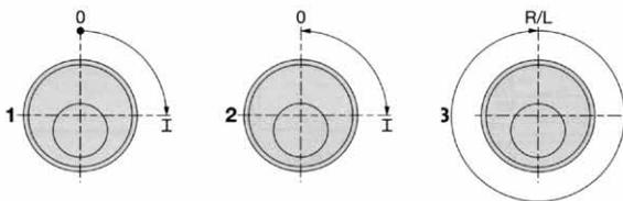
Nach Schlüsseldrehweg 90° rechts = Schalterstellung I, Schlüssel nicht abziehbar
