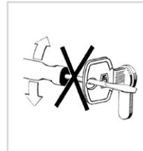
Am Schlüsselkopf dürfen keine Hilfsmittel (Zange, Nagel o.a.) angesetzt werden.
