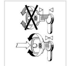
Schlüssel erst vollständig einstecken, bevor das Drehmoment übertragen werden darf zu pflegen.
