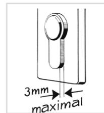
Zylinder darf maximal 3 mm aus Beschlag herausragen.
