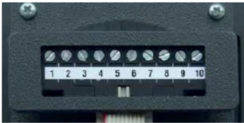
Diese Leser werden über folgende Klemmen mit dem ENIQ Module Reader/Module Reader Terminal verbunden:
