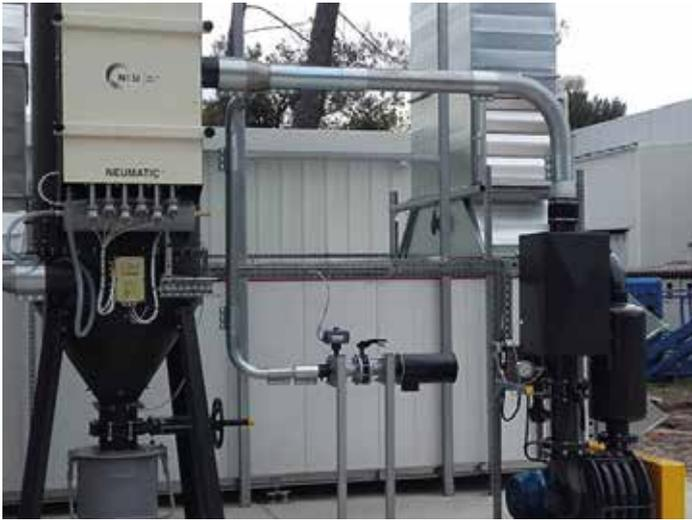
Un sistema de aspiración centralizada aspira de manera eficaz las partículas de polvo generadas durante todo su proceso, ofreciendo una limpieza completa del suelo, de los equipos y de las máquinas de producción.
