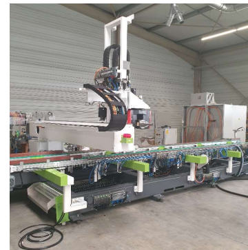
Centre d’Usinage de Massay
