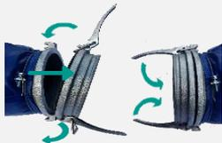
Assemblage des plots puis verrouillage avec poignées
