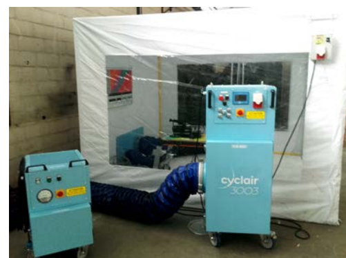
SAS de confinement souple mis en dépression par un CYCLAIR ® 3003 et un CYCLAIR ® 503
