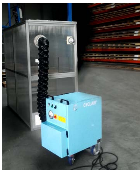
SAS rigide mis en dépression par un groupe déprimogène CYCLAIR ® 502
