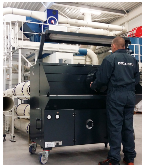
Werktafel met geïntegreerde filtratie en ventilator
