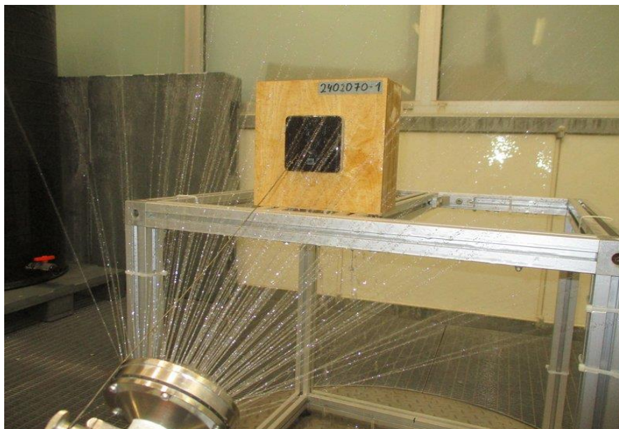
Prüfling während dem IPX4 Test
