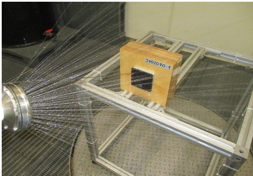
Prüfling während dem IPX4 Test
